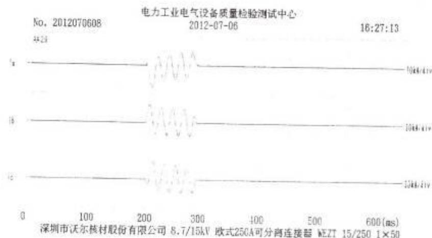
E2 组合试样热稳定试验波形 (导体)
